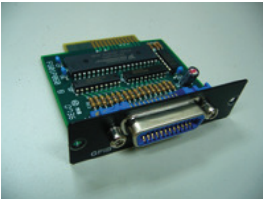
GPIB PCB (FG01P060)
